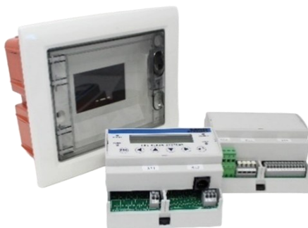
Abbildung 1: Version Türeinbau mit 3 Einzelkomponenten
